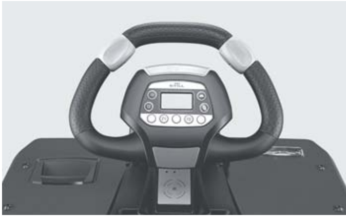
Uniek STILL Easy Drive-stuur voor het beste rijgevoel en bediening van alle functies zonder de handen te hoeven verplaatsen 2
