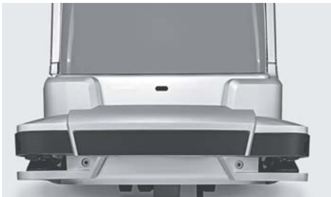
360° persoonlijke bescherming door geïntegreerde veiligheidslaserscanners in de LTX 50 iGo systems
