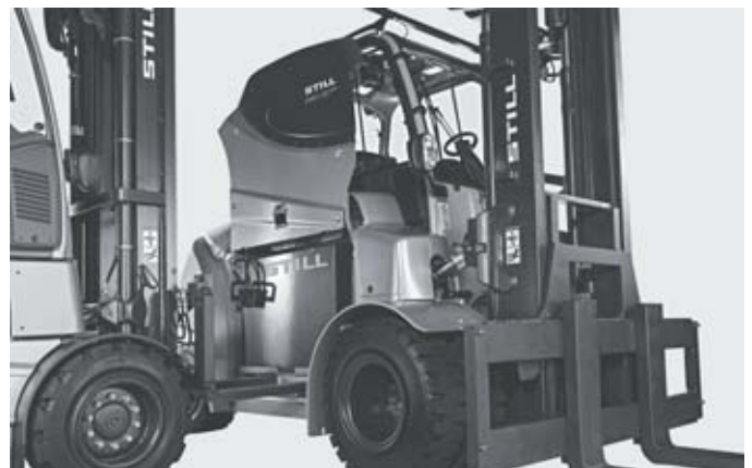
Hoge beschikbaarheid dankzij snel wisselen van de batterij
