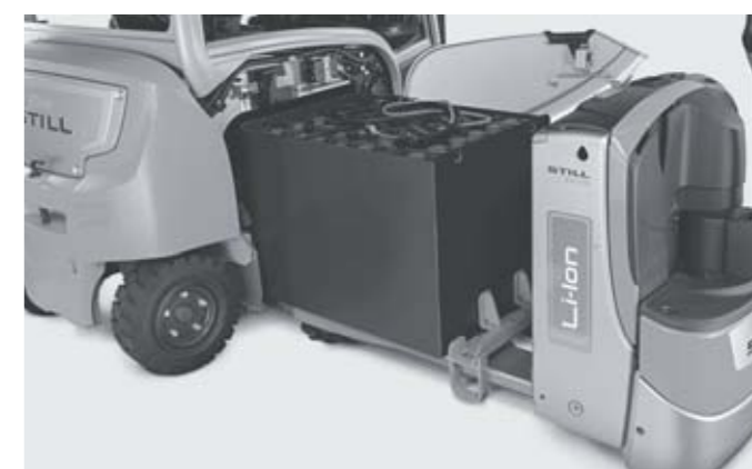
Batterij verwisselen met elektrische pallettruck
