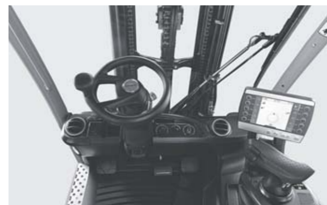
Werkruimte met display en bedieningen, Joystick 4Plus en verwarming
